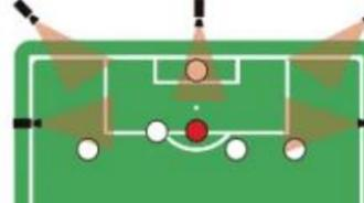
Se implanta un sistema automático de detección de extremidades llamado limb-tracking que permite detectar los 29 puntos corporales con los que se puede marcar gol hasta 50 veces por segundo. Para ello, se necesita un número de entre 10 y 12 cámaras instaladas a lo largo de la cubierta del estadio
